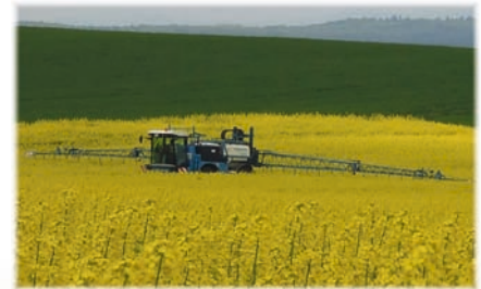
Rapsblütenbehandlung mit Dropleg UL -Technologie.
