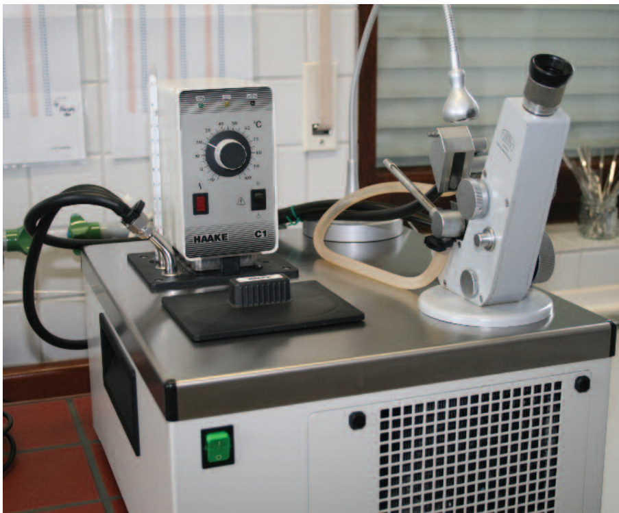
Der Refraktometeraufbau in der Honiguntersuchungsstelle des D.I.B.
